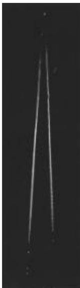
*Abb. 4. Die leuchtende Kante am Dreieckspalt. Eine Quecksilber-Höchstdrucklampe mit Grünfilter beleuchtete über einen Kondensator eine Durchmesser 0,1 mm Öffnung. In 1 m befand sich der Dreieckspalt, ein Rasierklingspalt mit 3 mm Basisbreite. Eine Kamera mit doppeltem Bodenauszug und Tessar 1 : 4,5,  $f' = 13,5$  cm war auf den Dreieckspalt scharf eingestellt und so weit seitlich gestellt, daß das direkte Licht neben das Objektiv fiel..*
